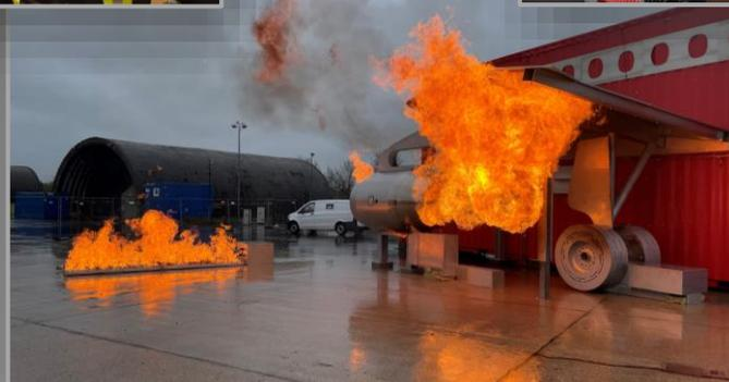
Diese Trainingsanlage ist so aufgebaut, dass sich verschiedenen Einsatzszenarien darstellen lassen. Die Brandstellen können so beispielweise zum Teil unterschiedliche positioniert und an mehreren Stellen Leitern, Treppen oder Rampen angebracht bzw. abgebaut werden. Neben klassischen Feuerwehreinsätzen lassen sich auch Aircraft-Crew und individuelle Trainings konzipieren und durchführen. Die vielseitigen Einsatzmöglichkeiten dieser Trainingsanlage sind im Kern in drei Teilbereiche unterteilt:
